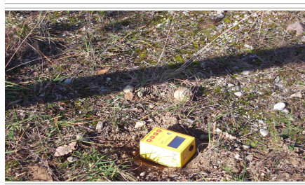
FIG. 2: INDAGINE SISMICA PASSIVA CON TROMINO
